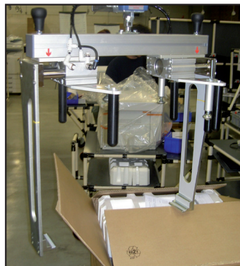
Spezialwerkzeug zum Heben von Druckern.
