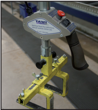
Gabelwerkzeug wird zum Heben von Aluminiumprofilen angewandt.
