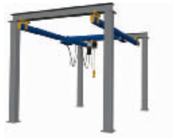
LR120/170 Stahlprofile in einem Niedrigbausystem. SWL bis zu 1.500kg mit verstärkten Profilen. Die freistehende Portal-Befestigungsstruktur ist eine Alternative zur Decken- und Wandaufhängung.
